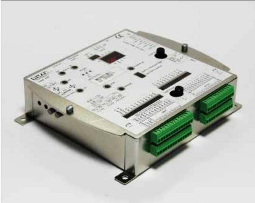
Il PLC PM2 è un dispositivo elettronico dotato di scheda programmabile multifunzione, con un'ampia varietà di ingressi e uscite (digitali e analogiche) per soddisfare tutte le esigenze di un'applicazione di controllo industriale.
